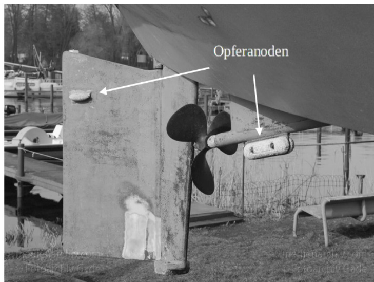
Abbildung 2: Schiffsrumpf: Schiffsschraube und Ruderblatt mit Opferanoden aus Zink (Quelle: https://www.oxly.de/foto/displayimage.php?pid=4976 )
